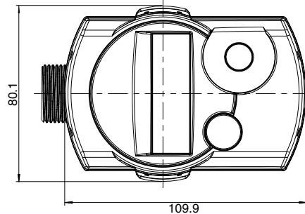
Рис.: Размеры компактных однопоточных счетчиков серии **SENSOSTAR®2** и **SENSOSTAR®2+**
