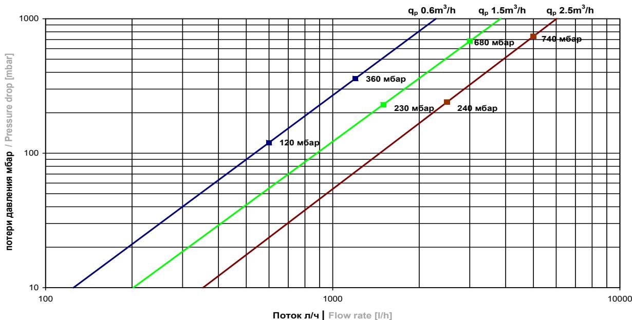
Рис.: потери давления компактных теплосчетчиков **SENSOSTAR® 2 QStar** и **SENSOSTAR® 2+ QStar**
