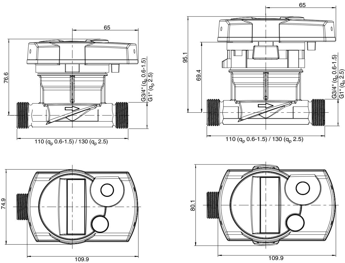
Рис.: Размеры компактных счетчиков **SENSOSTAR®2 QStar** и **SENSOSTAR®2+ QStar**
