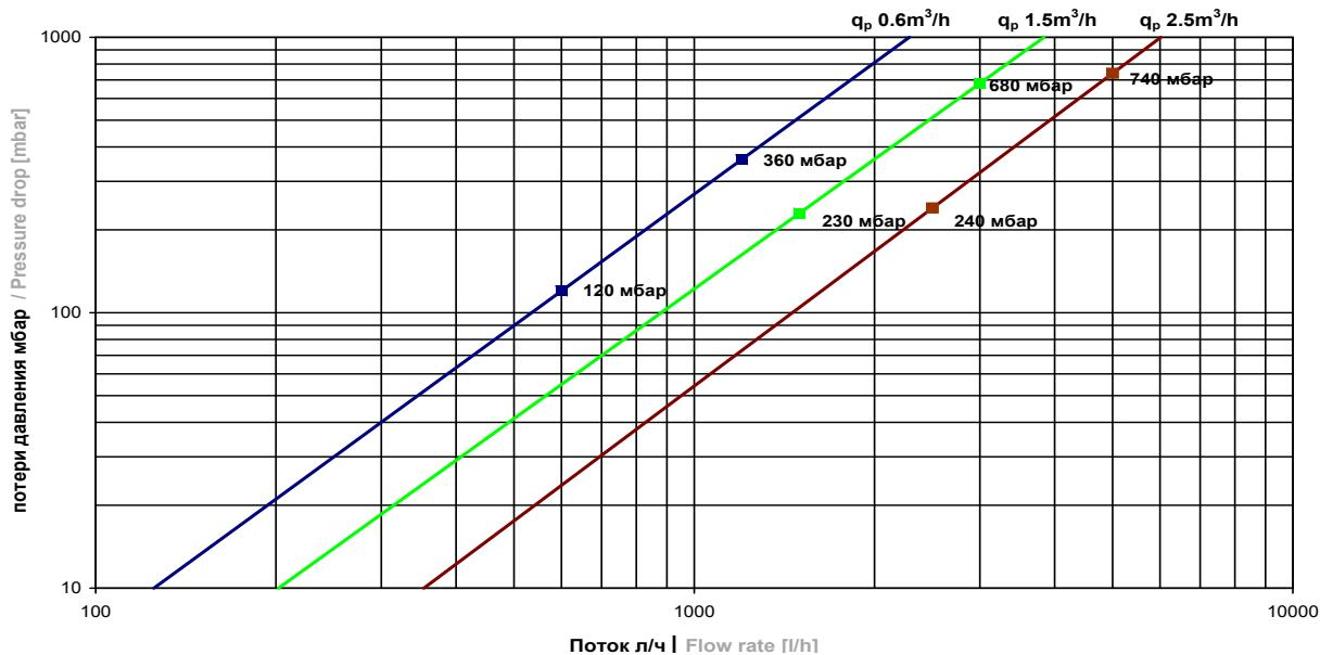
Рис.: Падение давления компактных коаксиальных многопоточных счётчиков серии **SENSOSTAR®2** и **SENSOSTAR®2+**
