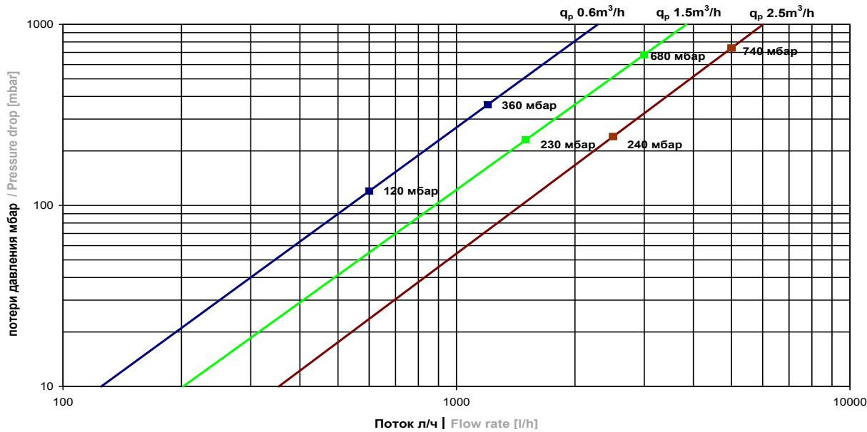
Рис.: Падение давления коаксиального многопоточного компактного счетчика **SENSOSTAR®2+** A-Star
