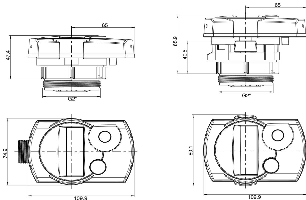
Рис: Размеры компактных многопоточных теплосчётчиков серии **SENSOSTAR®2** и **SENSOSTAR®2+**
