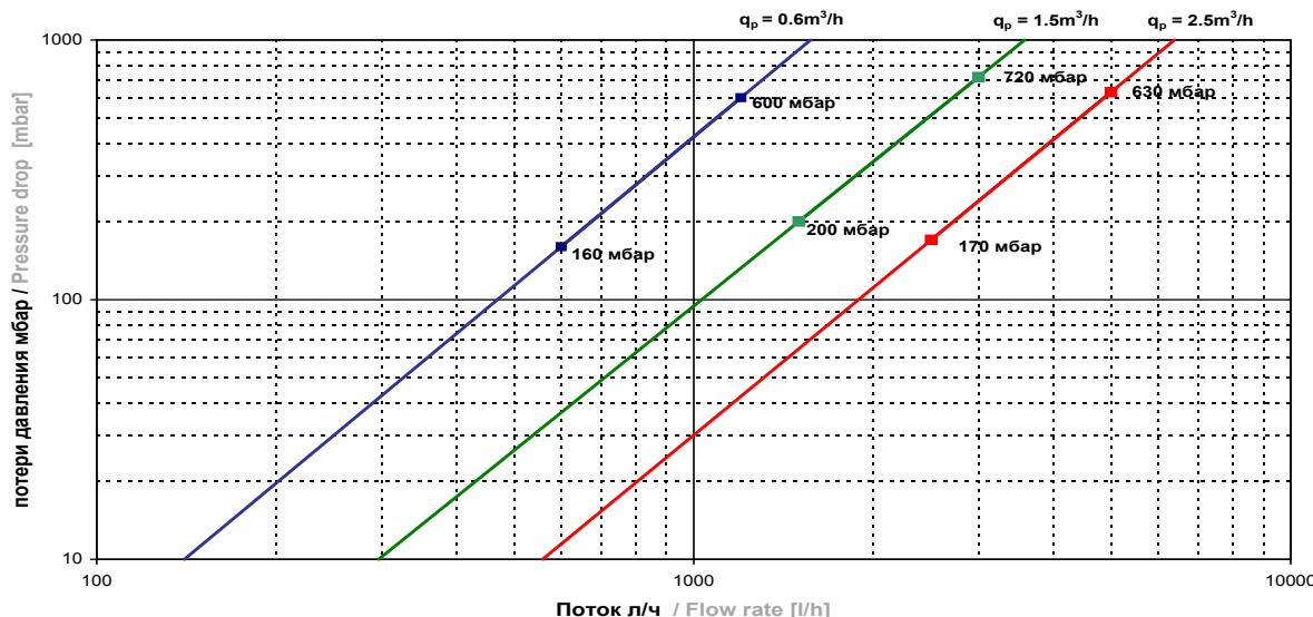
Рис.: Падение давления одноструйных компактных счётчиков тепла **SENSOSTAR®2** и **SENSOSTAR®2+**
