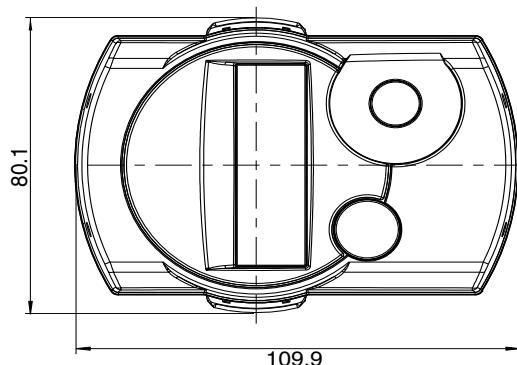
Рис.: Размеры компактного многопоточного коаксиального AStar теплосчёта **SENSOSTAR®2+**
