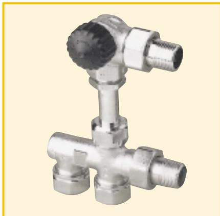
HEIMEIER Duolux представляет собой полную серию клапанов, предназначенных для двухтрубных систем отопления. Клапана подключаются к радиаторам и в однотрубных схемах отопления. Duolux состоит из двухтрубного распределителя, соединительной трубы и терморегулирующего клапана с черным защитным колпаком. Корпус изготовлен из никелированного коррозионно-стойкого бронзового сплава, и может присоединяться к пластиковым, медным, стальным тонкостенным, или металполимерным трубам.
