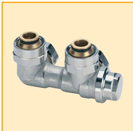
Арматура Vekolux, из ассортимента PROFI-LINE фирмы HEIMEIER используется для нижнего подключения радиаторов, закрытия и дренирования. Шпиндель для параллельного отключения подводящей и возвратной трубы в ходе одной операции. Настраивается универсальным ключом фирмы HEIMEIER.
