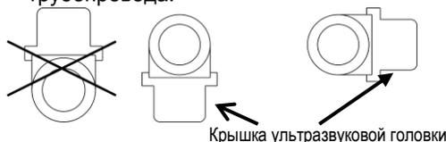
Рис. 6: Рекомендуемое положение монтажа при измерении энергии охлаждения
